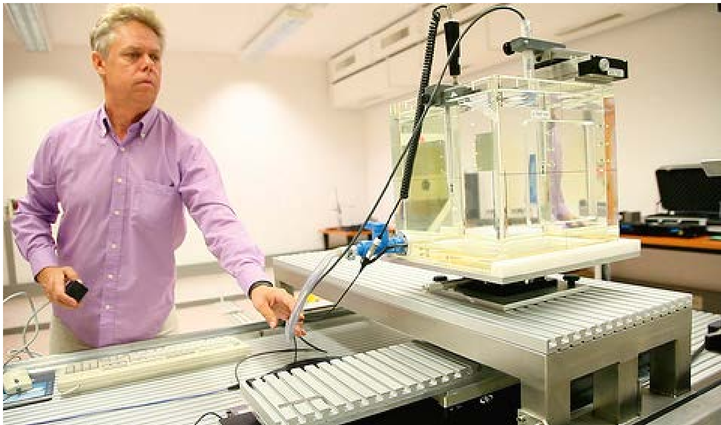
Configuration d'un appareil d'étalonnage de dosimétrie au Laboratoire de dosimétrie de l'AIEA (Photo : Rodolfo Quevenco, AIEA)
