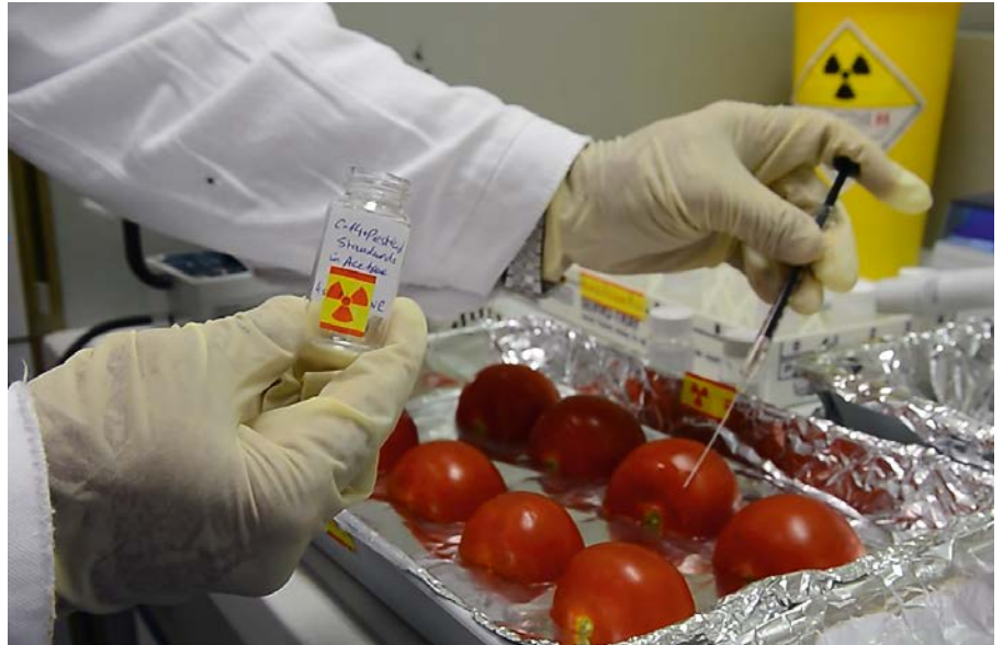
Formation de scientifiques des États Membres au Laboratoire de la protection des aliments et de l'environnement sur l'utilisation des techniques des radiotraceurs pour gérer les risques associés aux résidus de pesticides dans les aliments. (Photo : Dean Calma, AIEA)
