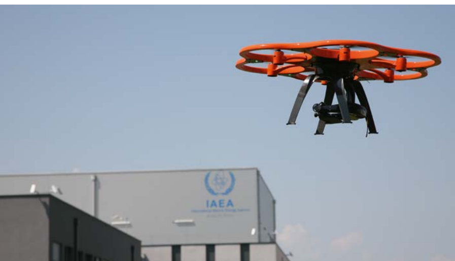
Drone conçu par le NSIL pour le contrôle radiologique à distance de l'environnement. (Photo : Steve Thachet, AIEA)
