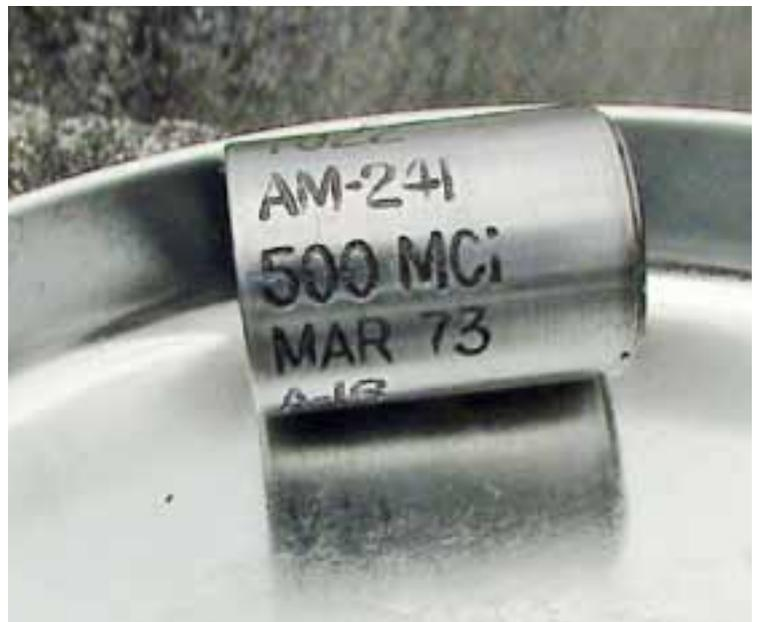
4 密封放射源或“密封源”是已被隔离/密封在如图所示小金属容器中的放射性物质。密封源应用于许多领域，如医学诊断和治疗、工业过程控制、食品和医疗用品灭菌。
