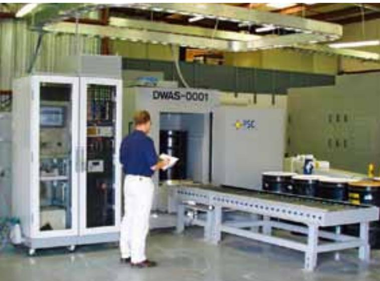
无源-有源中子微分衰减系统(PANDDA™)，废物桶监测高分辨率γ能谱系统
