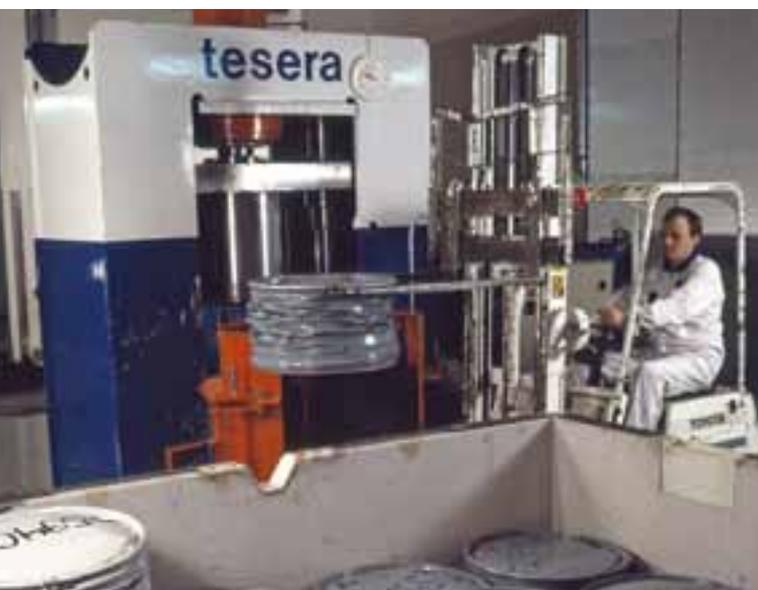
固体废物桶超级压缩机
