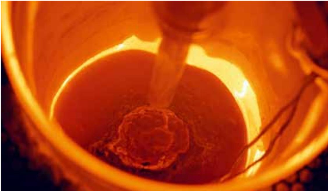
玻璃固化是对放射性废物和危险化学品废物进行整备的实际和有效方案。
