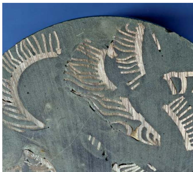
Герметизированная в цементе оболочка топлива из магнокса в Селлафилде. (Фото: "Селлафилд, лтд.", Соединенное Королевство)
