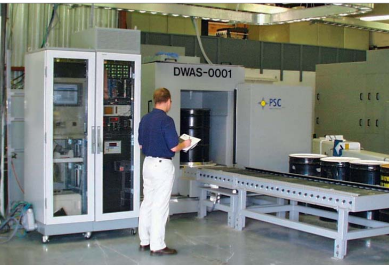
Пассивно-активная система анализа нейтронного потока методом дифференциального затухания (PANDDATM) – система гамма-спектрометрии высокого разрешения с устройством контроля контейнеров. (Фото: "Пахарито сайенцифик корпорейшн", США)
