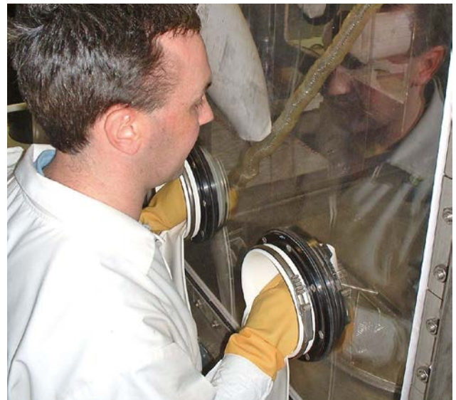
Poste de tri pour la séparation des déchets (Photo : Downreay Site Restoration Ltd et Autorité du déclassé nucléaire (NDA), Royaume Uni)
