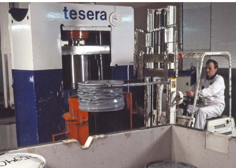
Supercompacteur de fûts de déchets solides (Photo : Teollisuuden Voima Oyj (TVO), Finlande)
