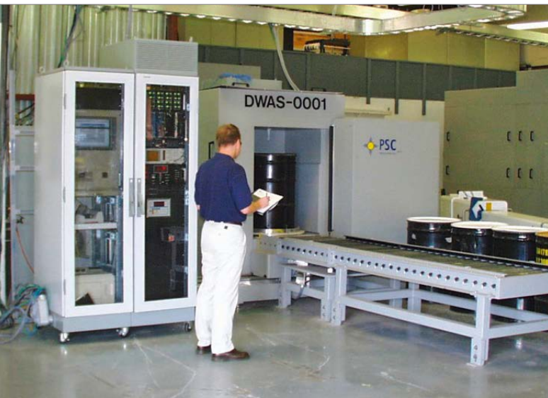
Passive Active Neutron Differential Die-Away System (PANDDATM), système de spectrométrie gamma de haute résolution pour le contrôle de fûts. (Photo : Pajarito Scientific Corporation, États-Unis)
