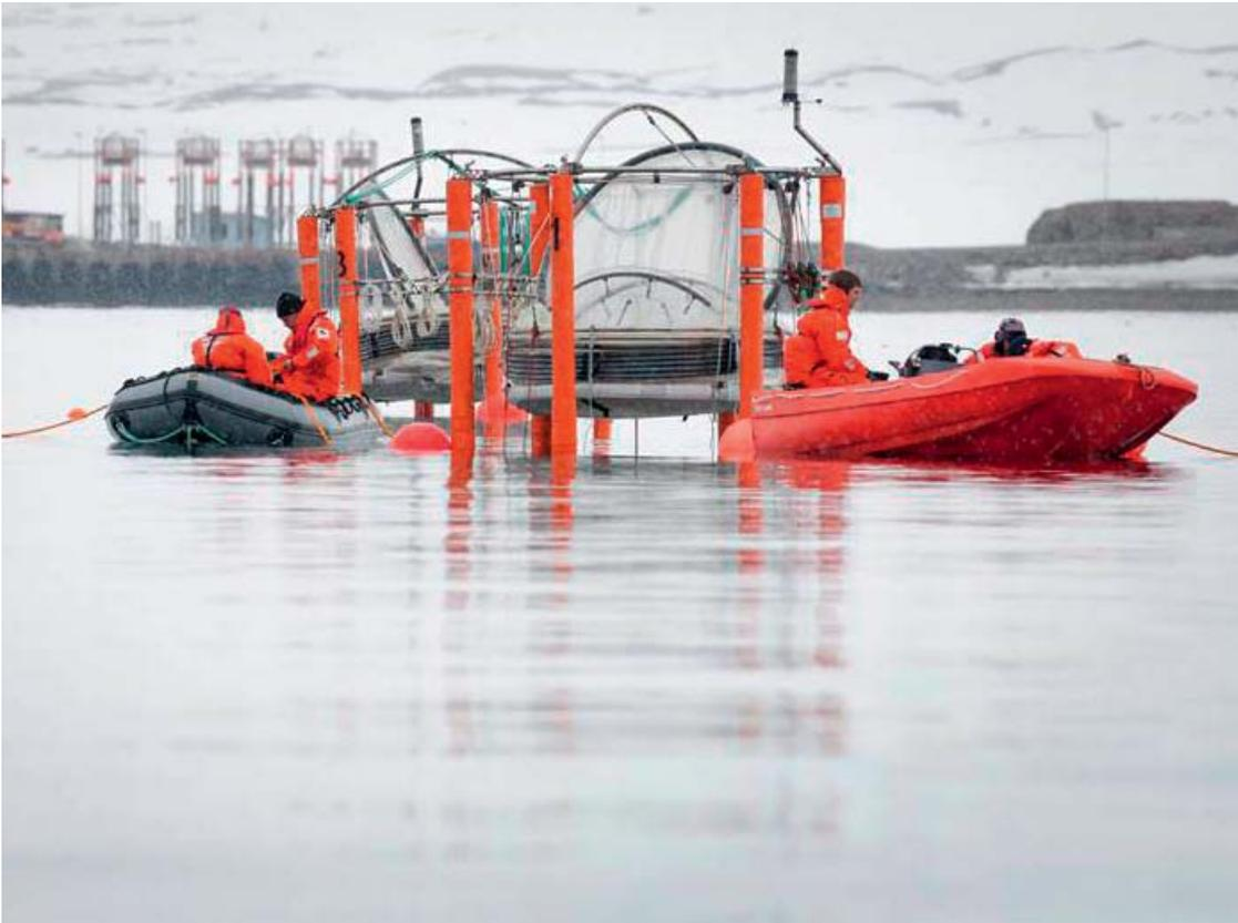
Исследования с помощью радиоиндикаторов могут проводиться в плавающих или устанавливаемых на морском дне тентово-каркасных конструкциях, которые называются мезокосмы. Эти ценные экспериментальные средства позволяют изучать природную среду в контролируемых условиях, давая возможность сочетать преимущества работы в лаборатории и при полевых испытаниях.
