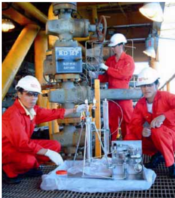
РИС. 1. Инъекция радиоиндикаторов на морской нефтепромысловой платформе во Вьетнаме.
