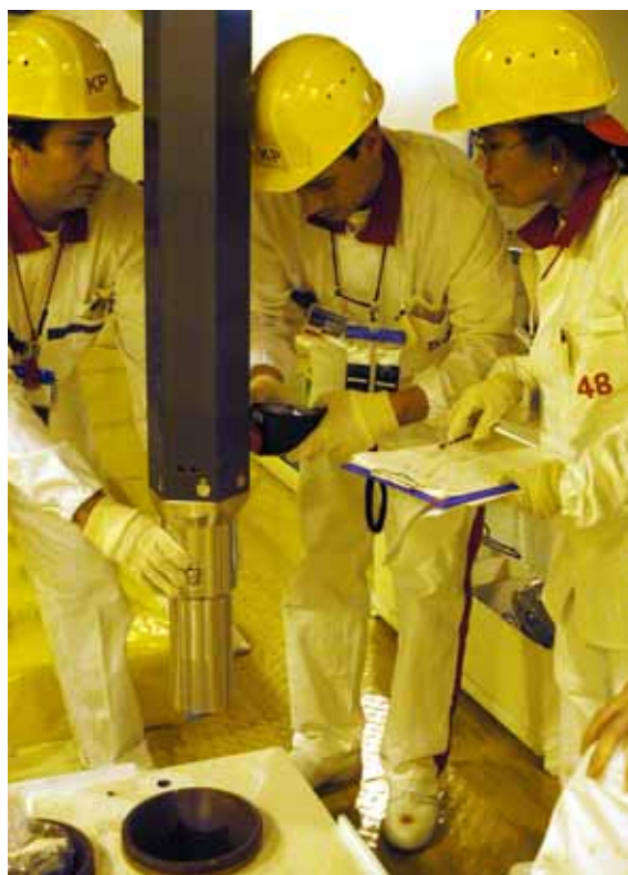
РИС. 1. На АЭС "Моховице" в Словакии инспекторы по ядерным гарантиям в ходе учений проверяют активную длину свежей топливной сборки, используя гамма-лучевую систему.
