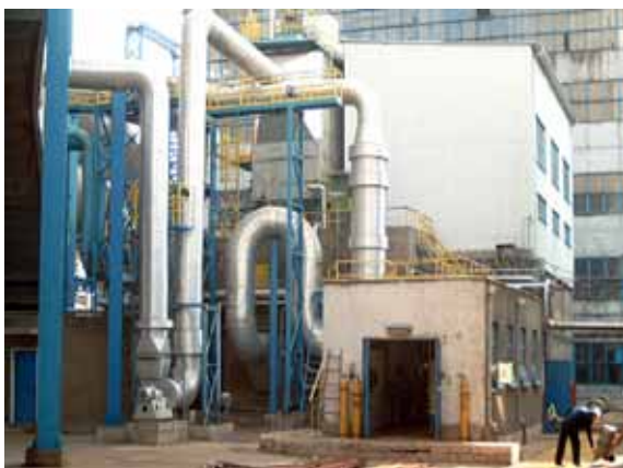
Рис. 1. Опытная установка для электронно-лучевой обработки отходящих дымовых газов на теплоэлектростанции "Марица Восток-2" в Болгарии.
