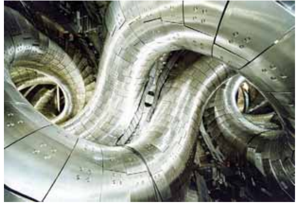
РИС. 2. Внутренний вид вакуумной камеры японского стелларатора LHD — тороидальная концепция удержания плазмы при термоядерном синтезе; показаны имеющие покрытие витки спиральной системы. Плазма термоядерного синтеза удерживается в змеевике внутри вакуумной камеры.
