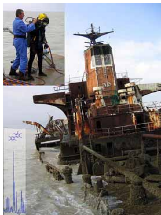
РИС. 2. Отбор проб загрязнения (верхняя вставка) и хроматографический анализ (нижняя вставка) отложений, отобранных на обломках одного из 35 судов в иракских водных путях и их окрестностях.
