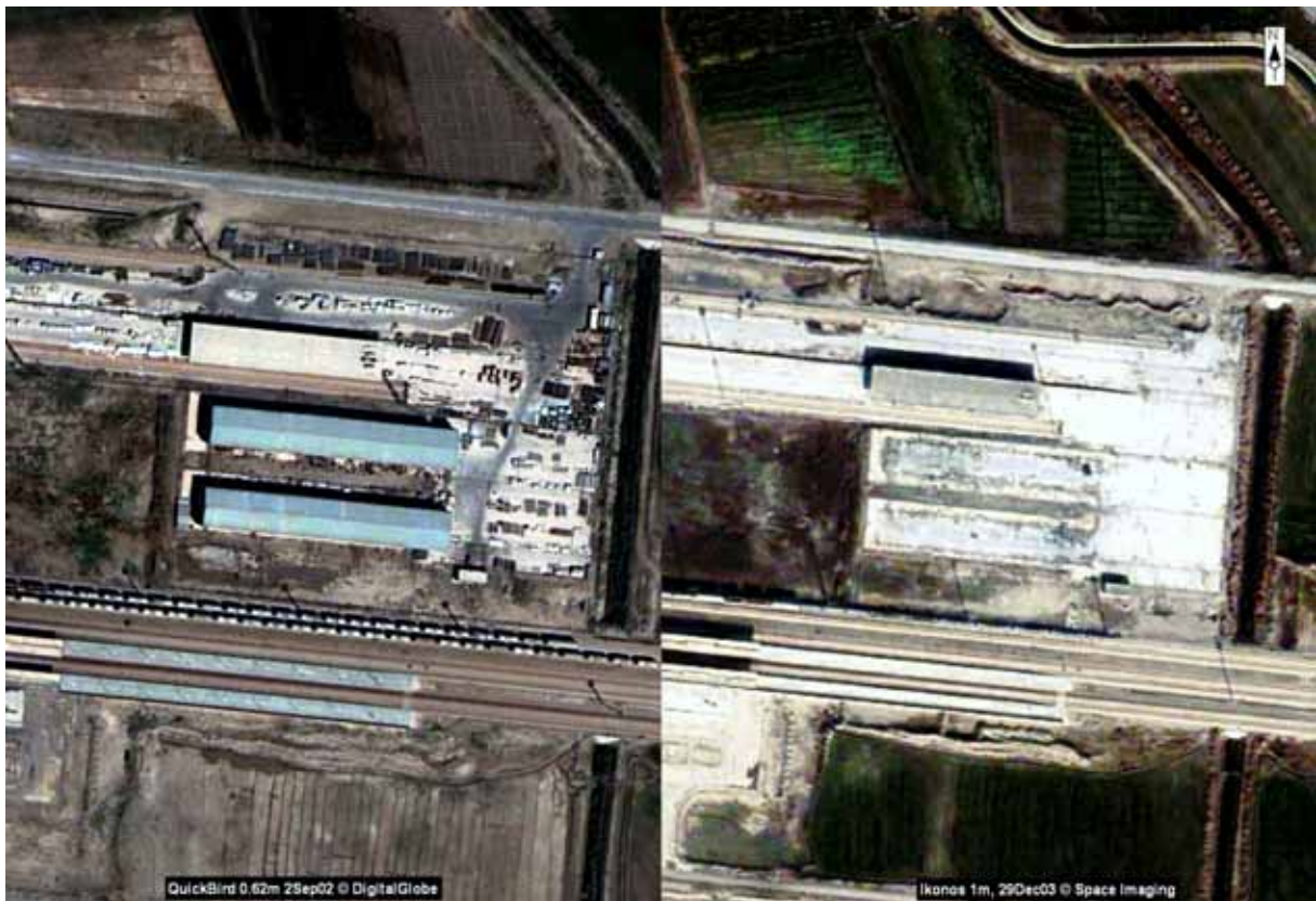
Рис. 1. Пример спутникового изображения, использованного для анализа обнаружения изменений, который включает сравнение объекта, снятого в две различные даты, с тем чтобы обновить знания Агентства в отношении инфраструктуры и существования объекта. Изображение слева сделано спутником Quickbird с высоты 450 км, в то время как изображение справа - спутником Ikonos с высоты около 680 км (авторские права: QuickBird DigitalGlobe; и Ikonos Space Imaging).
