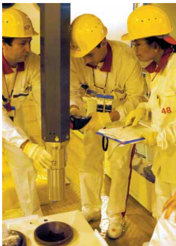
图 1. 在一次培训活动期间，核保障视察员正在斯洛伐克 Mochovce 核电厂利用 \gamma 射线系统核查一个新燃料组件的活性长度。
