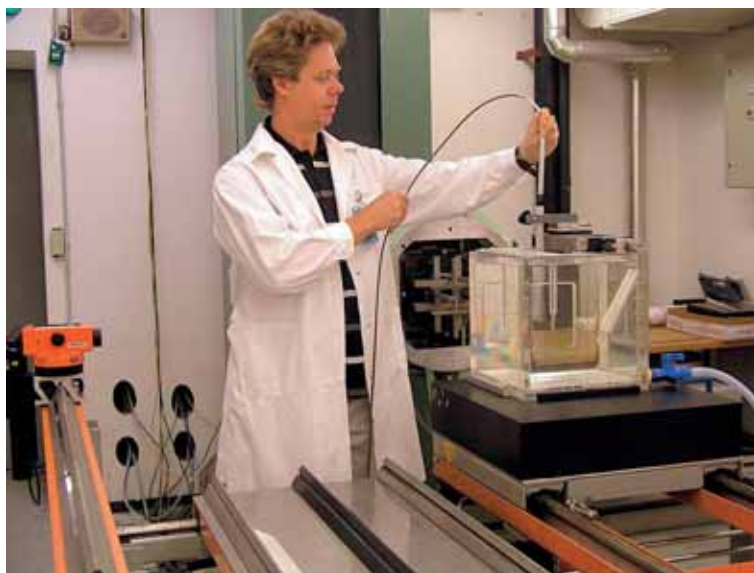
图 3. 辐射剂量测量的准确性在放射治疗中至关重要。图中，原子能机构塞伯斯多夫实验室的一名物理学者正在校准即将在成员国使用的剂量计。
