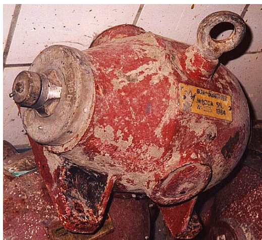
FIG. 2. Source radioactive retirée du service (capteur de niveau au césium 137).
