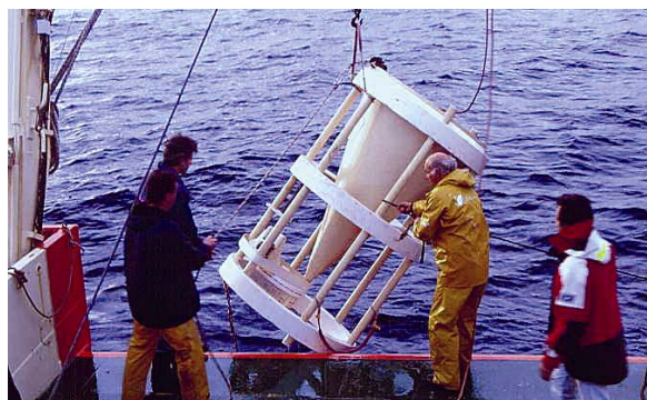
图 1. 利用粒子捕集器测量海洋碳同位素和沉降情况。
