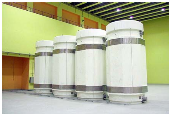
图 2. 瑞士 Würenlingen 中间贮存设施的临时贮存和运输容器。
