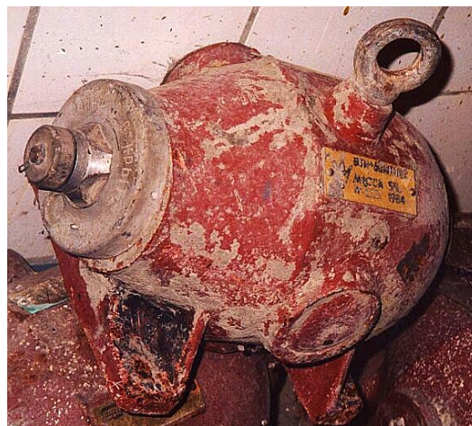
图 2. 废放射源（带铯-137 的活度仪）。
