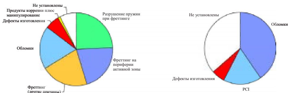
РИС.1. Причины отказа топливных стержней в Фраматоме – топливо ANP в период 1991-2002 годов для PWR (слева) и BWR (справа) (PCI: взаимодействие топлива с оболочкой). Наведенные потоком вибрации включают все три указанные на диаграммах категории фреттинга.
