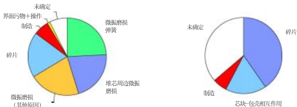
图1. 1991—2002年压水堆（左）和沸水堆（右）用法玛通-ANP燃料棒破损原因（燃料芯块-包壳相互作用）。流致振动包括图中所有3类微振磨损。
