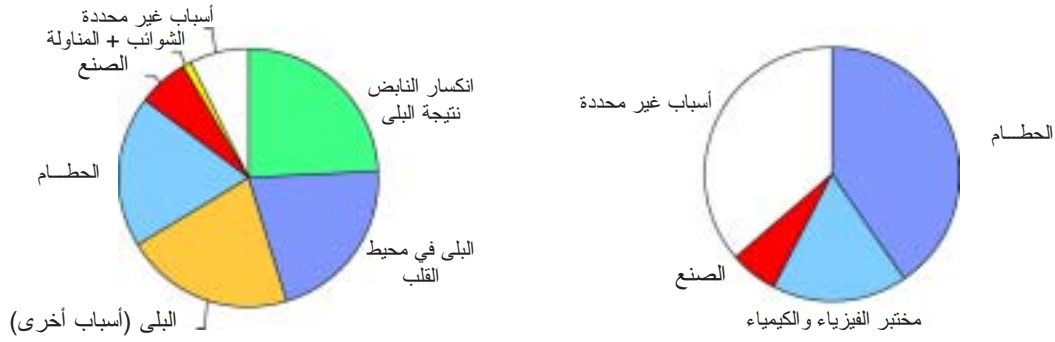
الشكل ١- أسباب قصور القضبان في وقود فراماتوم-ANP بين عامي ١٩٩١ و ٢٠٠٠ بالنسبة للمفاعلات من طراز PWR (يسارا) و BWR (يميناً) (مختبر الفيزياء والكيمياء والأجهزة: التفاعل بين الأقراص والكسوة). وتتضمن الذبذبات الناتجة عن التدفق جميع فئات البلى الواردة في الشكل.
