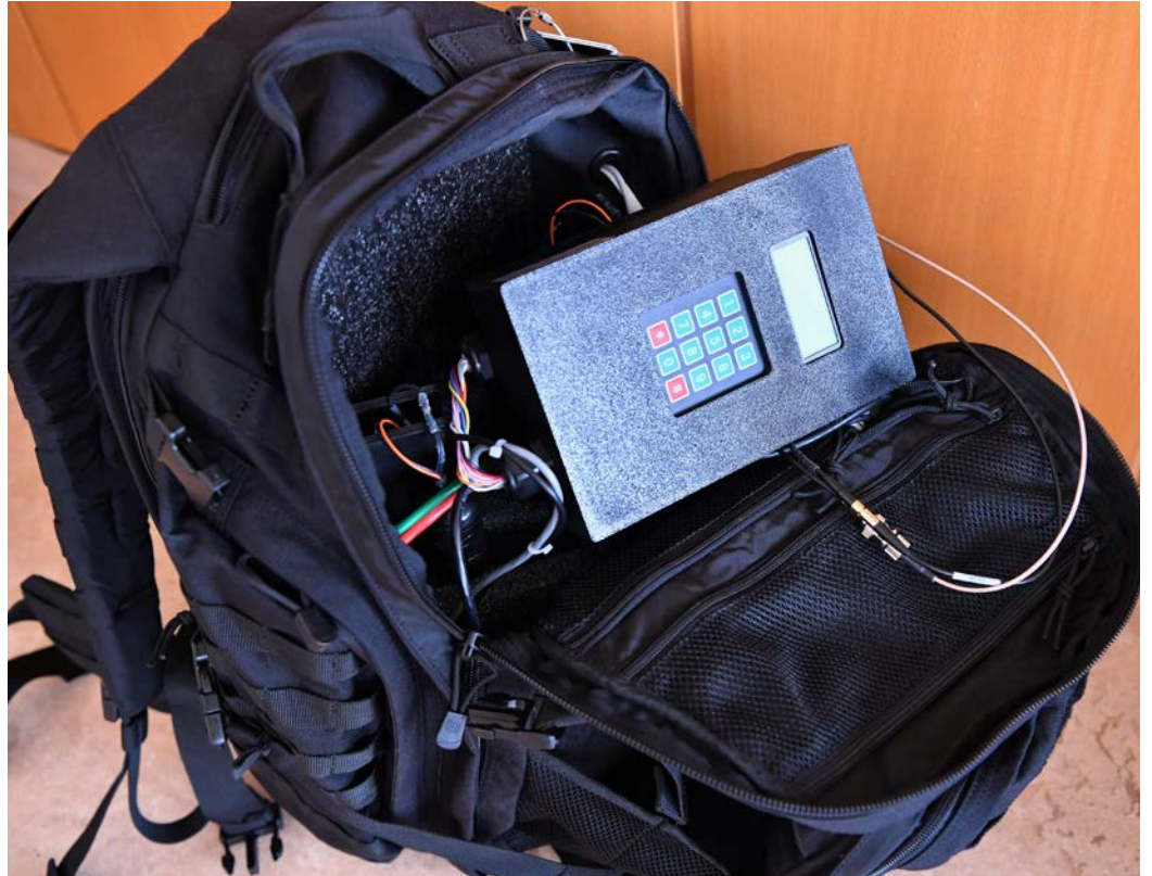
نظرة من الداخل لجهاز مسح إشعاعي يحمل على الظهر. (الصورة من: دين كالم/الوكالة)
