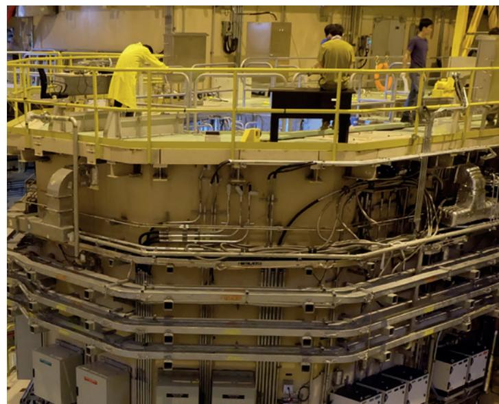
Los puertos de los haces de neutrones del JRTR se utilizarán para realizar experimentos y los agujeros de irradiación del interior del tanque servirán para producir radioisótopos con fines médicos e industriales, así como para otras actividades de investigación.
