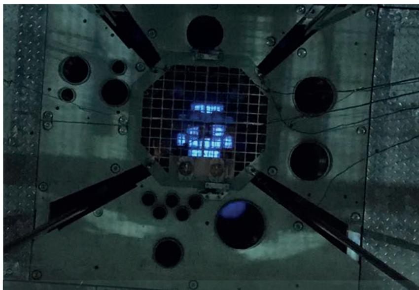
La brillante luz azulada que se observa en la piscina del reactor se debe a las partículas de electrones emitidas por el combustible y que interactúan con el agua. Esta penetrante luz azul se conoce como efecto Cherenkov. Conforme aumenta el nivel de potencia del reactor, este resplandor azul gana en intensidad.
