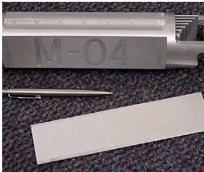
Placa de blanco de molibdeno 99 y el soporte utilizado para irradiar las placas en un reactor de investigación.
