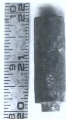
一个未加屏蔽的铯-137装置被发现埋在伊利诺斯州一家废金属厂的沙砾中。尺刻度单位为英寸。
