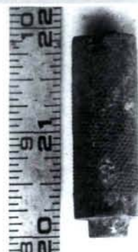
Fuente de cesio 137, sin blindaje, que se halló enterrada bajo gravilla en un depósito de chatarra, en Illinois. La escala está en pulgadas.
