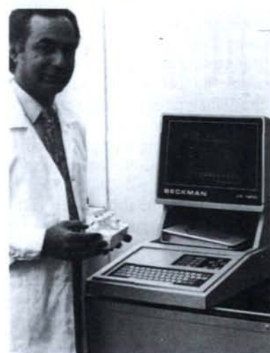
Compteur à scintillateur liquide de la section de chimie pour le dosage du strontium 90 et du tritium.
