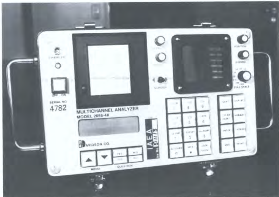
Рис. 1. Портативный многоканальный мини-анализатор. Три группы кнопок (внизу слева, в центре и справа) позволяют инспектору с их помощью настраивать прибор на чувствительность к командам, появляющимся на жидкокристаллическом дисплее (в середине слева). Спектры могут воспроизводиться на экране ЭЛТ (вверху справа) с помощью ручек вокруг экрана и записываться на кассетное записывающее устройство (вверху слева).
