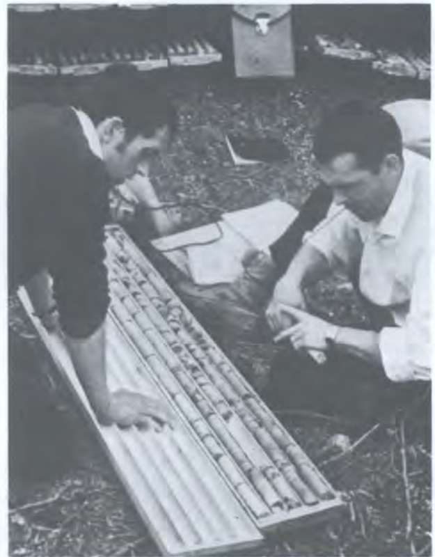
Рисунок 4. Исследование буровых колонок и отбор проб в Саскачеване, Канада. В целом этот метод является более дорогостоящим, чем каротаж скважин.
