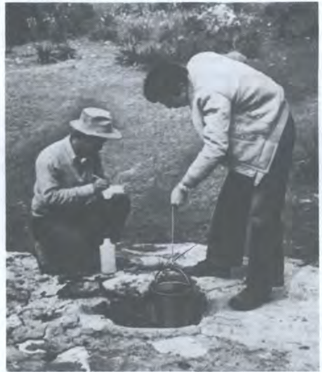
Рисунок 6. Отбор проб воды из домашнего колодца в Турции для анализа содержания урана и радона.
