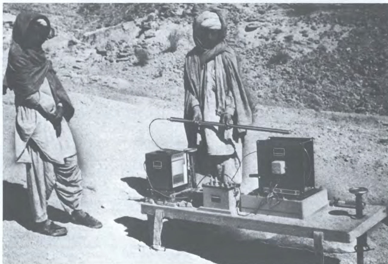
Рисунок 3. Каротаж скважины в Пакистане. Рабочий стоит около аппаратуры для регистрации данных каротажа и ручной лебедки, используемой для опускания зонда в скважину, и держит в руках зонд.
