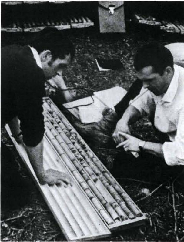
Figure 4. Examen et prélèvement de carottes de sondage au Saskatchewan (Canada). Ce procédé est en général plus coûteux que le radiocarottage.
