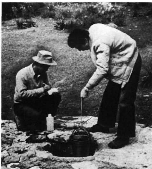
Figure 6. Prélèvement d'eau dans un puits familial en Turquie pour analyse de la teneur en uranium et radon.
