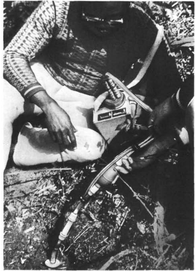
Figura 5. Medición del radón gaseoso del suelo.
