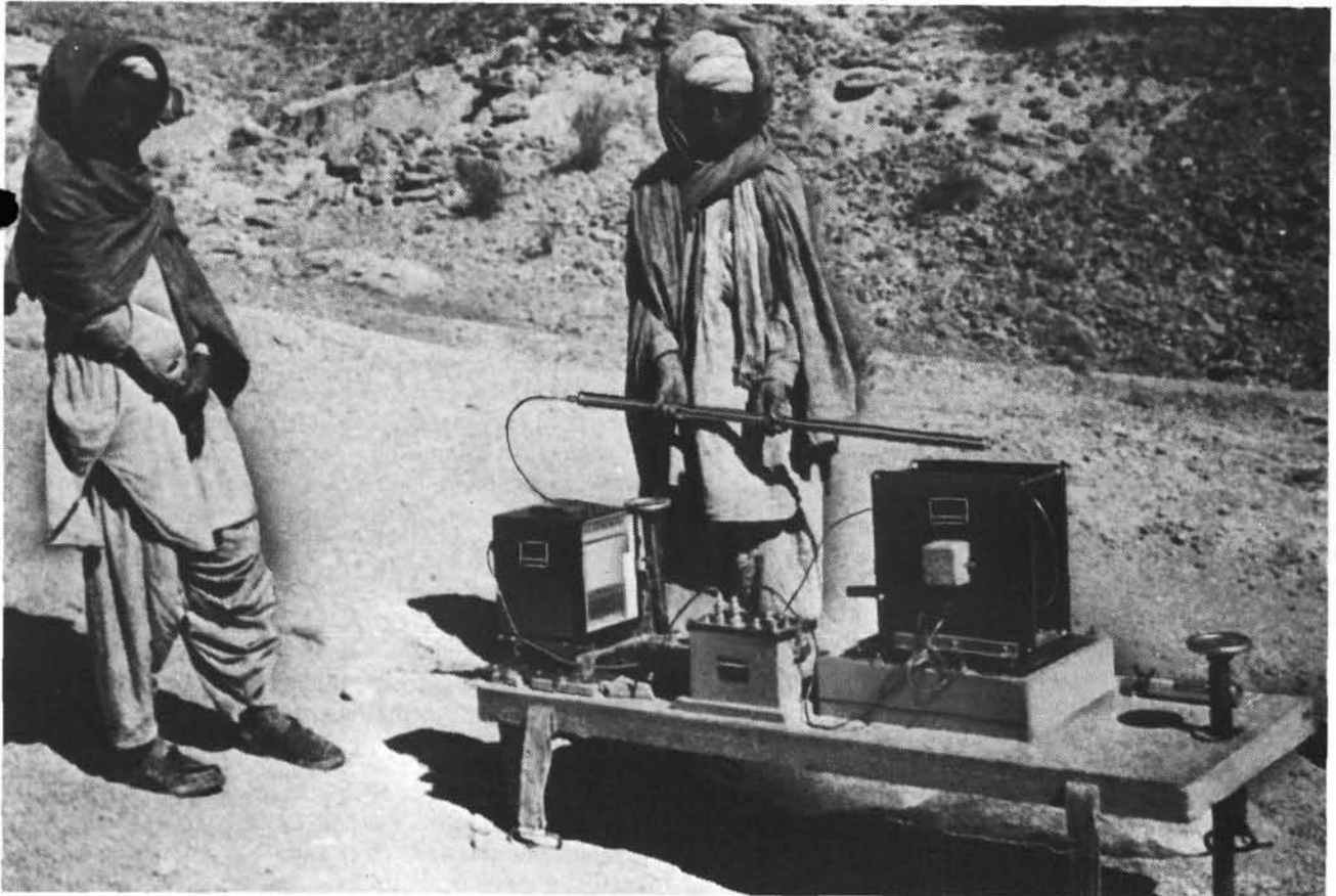
Figura 3. Perforando un pozo en el Pakistán. El trabajador está detrás del aparato de perfilaje y el torno utilizado para descender la sonda en el pozo; tiene entre sus manos la propia sonda.
