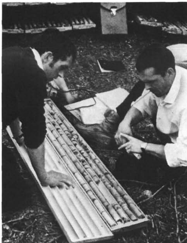
Figura 4. Muestreo y examen de testigos en Saskatchewan (Canadá). En general, esta técnica es más costosa que la perforación de pozos.
