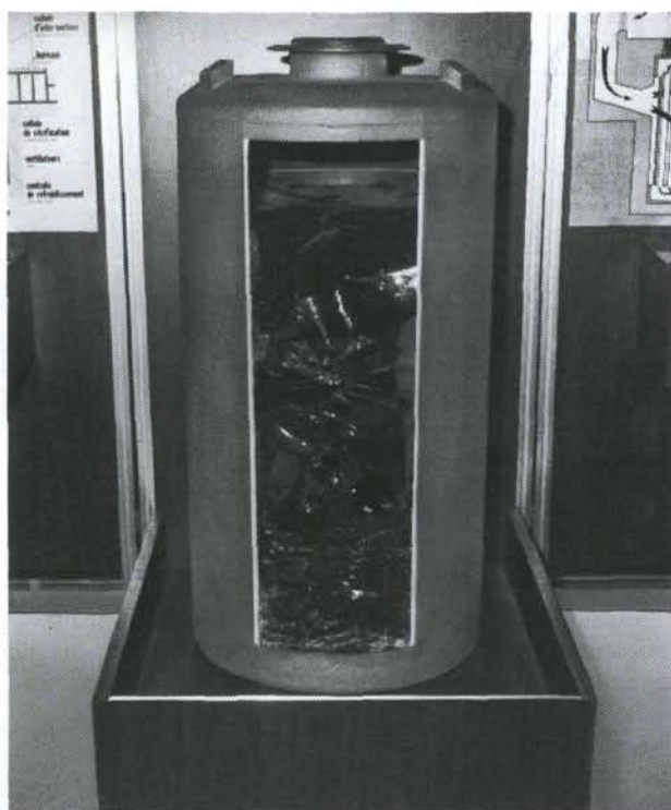
Modelo prototipo de recipiente para desechos radiactivos vitrificados; en el interior puede verse el vidrio borosilicado.
