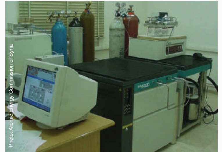
مرافق تحليل النظائر المستقرة في عينات المياه في هيئة الطاقة الذرية السورية (سوريا): المطياف الكتلي من طراز MAT DELTA plus
