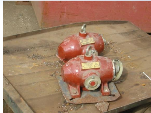
Disused density gauges Cs-137
