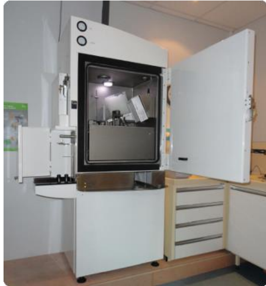
■ Système UniDose® de TRASIS shielding : 50 mm lead
