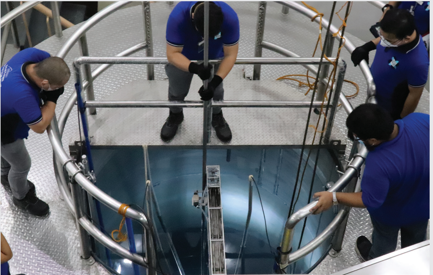
Топливный стержень загружается в активную зону подкритической сборки. (Фото: ФИЯИ)
