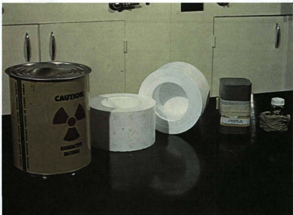
Photos 1a, 1b. Composants et montage d'un colis du type A.
