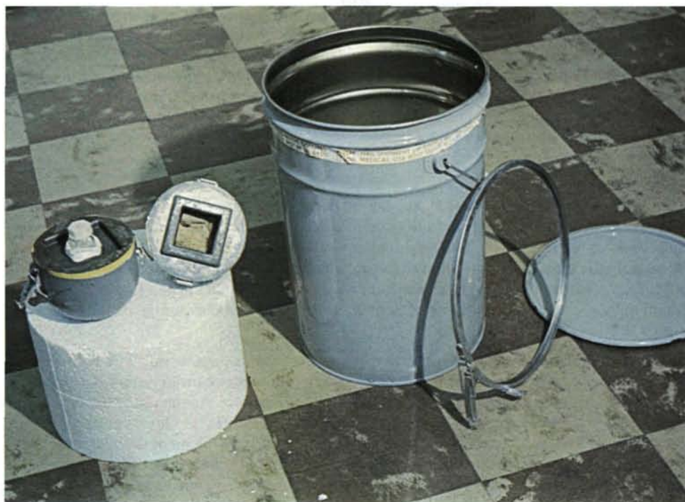
Photos 2a, 2b. Composants et montage de divers modèles d'emballages du type A.
