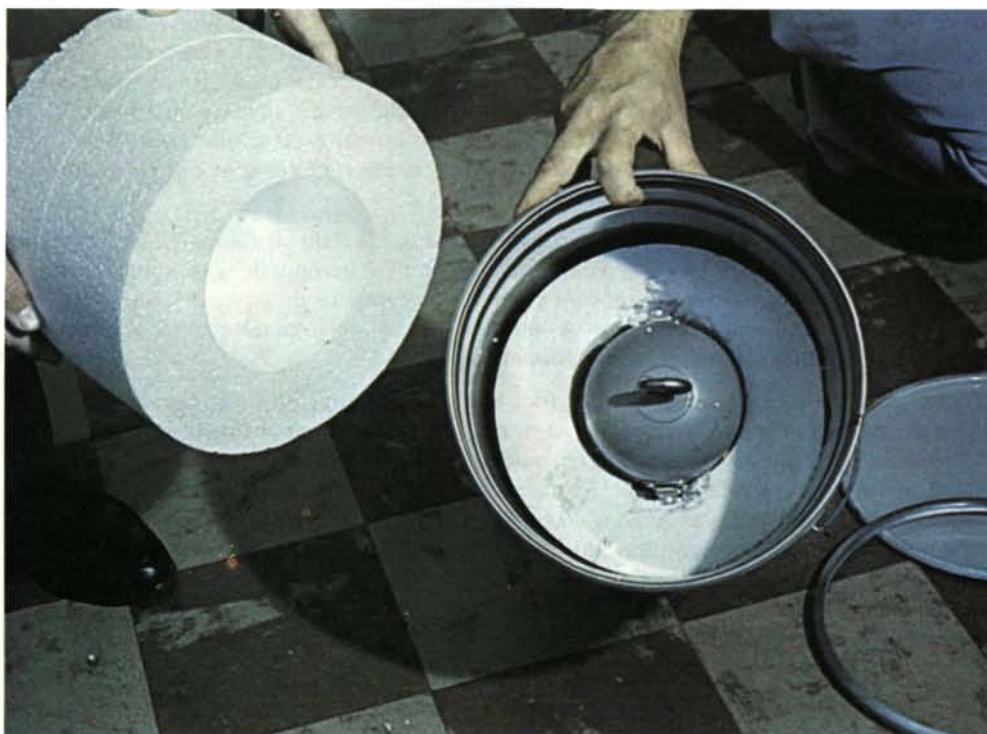
Photos 2a, 2b. Composants et montage de divers modèles d'emballages du type A.
