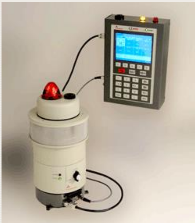
CAM para la detección de emisores alfa y beta en el aire
