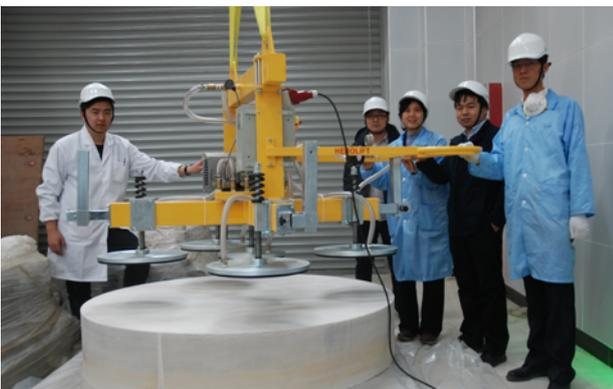
核工业北京地质研究院的科学家们在测试高放废物处置库缓冲材料膨润土砌块。国际原子能机构为废物处置提供了地质、水文地质和力学研究方面的技术援助和人员培训。(图/北京地质研究院成功)
