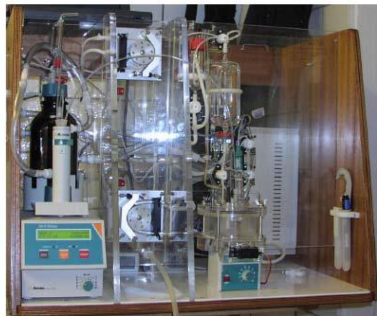
VINDTA 3S in the lab (VINDTA # 005)
