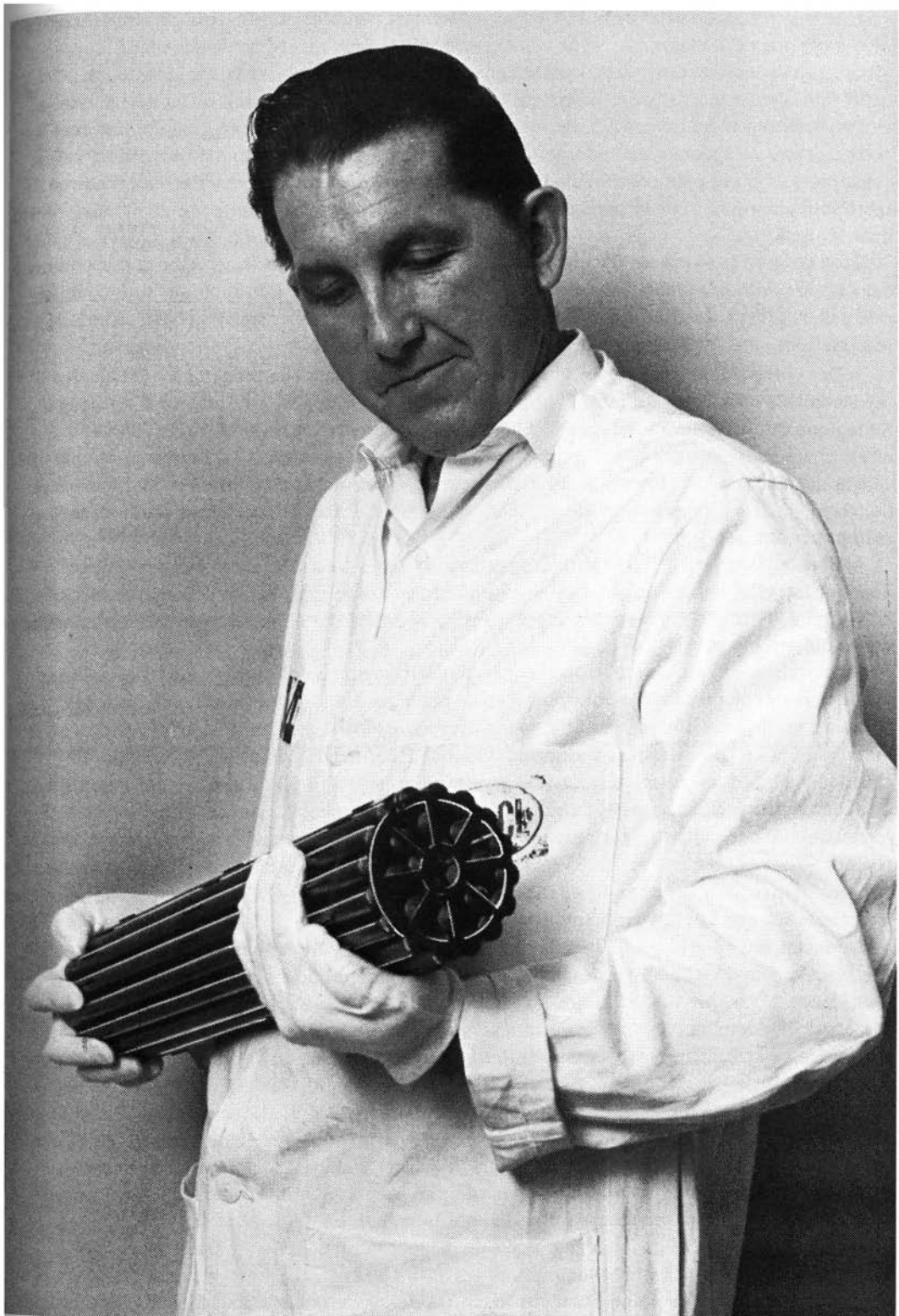
Faisceau d'éléments combustibles pour la centrale nucléaire de Pickering. Photo: Chalk River Nuclear Laboratories, Ontario.
