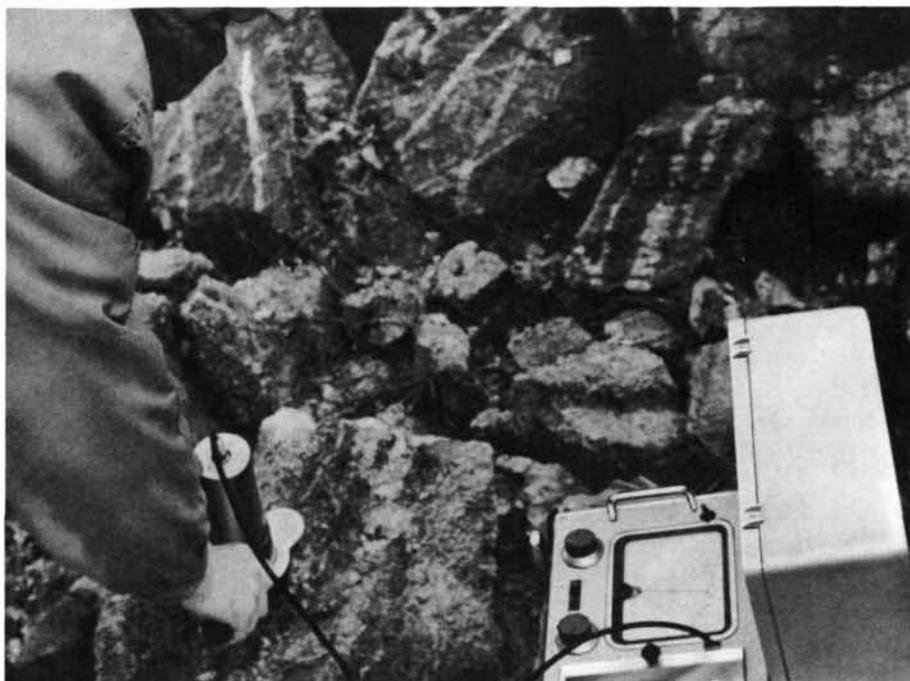
Prospection de minerai d'étain au moyen d'un analyseur portatif (Photo: Hilger and Watts Ltd.)
