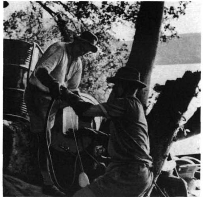
Remplissage de bouteilles en matière plastique avec de l'eau marquée au tritium: M. Proctor et M. T.T. Bestow, tous deux du service d'hydrologie du Ministère des travaux publics (Nairobi).
