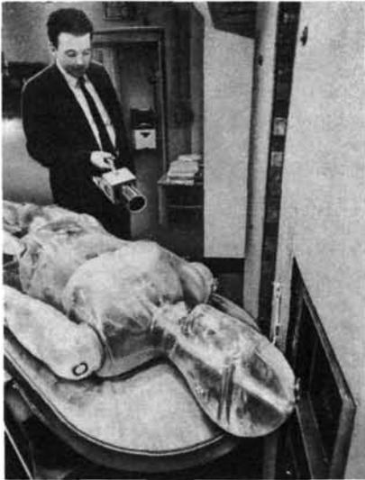
Maniqué representando el cuerpo humano, utilizado en el Laboratorio de Brookhaven para medir la penetración neutrónica en distintas partes del cuerpo. Los neutrones entran por la cabeza, situado cerca del portillo del reactor de Investigaciones médicas (foto Naciones Unidas)
