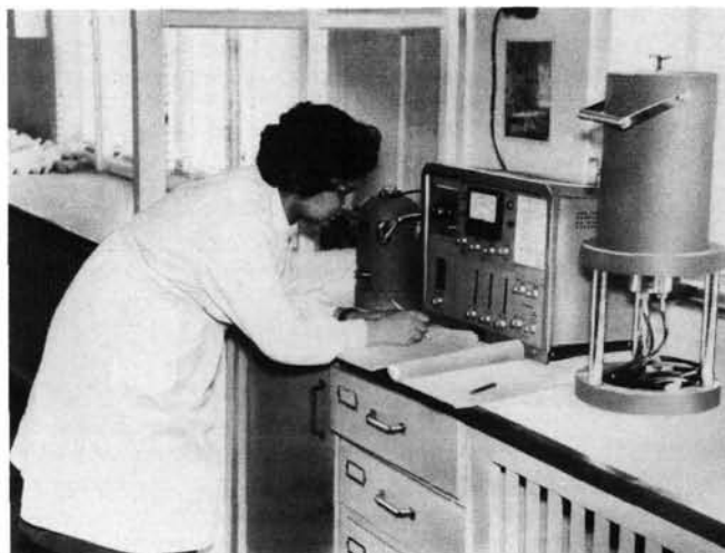
Une laborantine relève sur un intégrateur la radioactivité d'échantillons placés dans un détecteur
