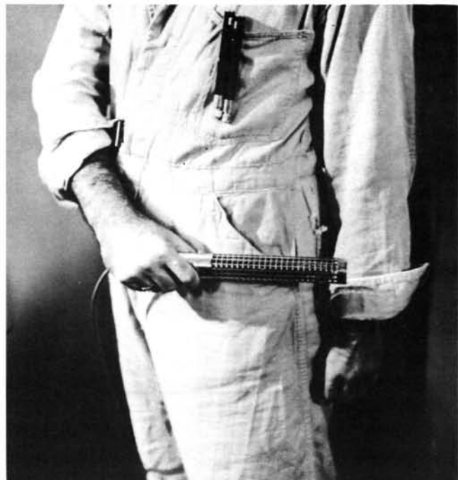
Instrument très pratique pour les travailleurs professionnellement exposés, car il permet de contrôler toutes les parties du corps et les vêtements
