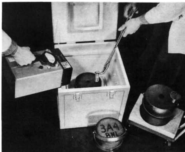
Application des règlements de sécurité aux Etats-Unis. Un échantillon radioactif, prêt à être expédié, est placé dans un écran en plomb, au centre d'une caisse en bois, en vue d'assurer la protection radiologique conformément aux règlements de l'Interstate Commerce Commission. Le dosimètre est une mesure de précaution pour le personnel.
