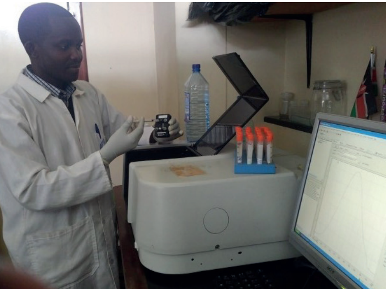
Лаборант анализирует пробы дейтерия в лаборатории инфракрасного спектрометра с преобразованием Фурье в Кении.
