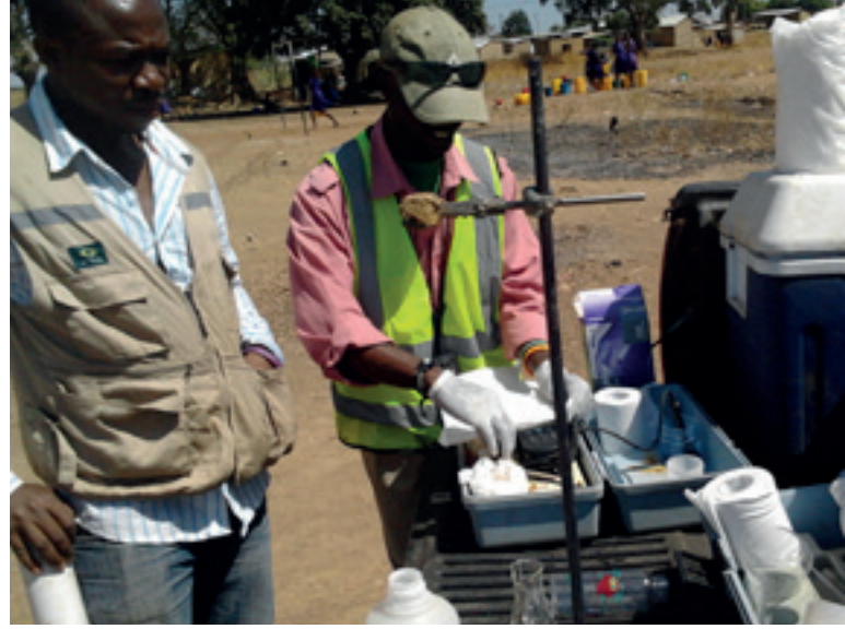
إعداد عينات لتحليل التريتيوم في المياه الجوفية، مختبر الهيدرولوجيا النظرية، هيئة الطاقة الذرية في غانا. (الصورة من: د. كالم/الوكالة الدولية للطاقة الذرية)
