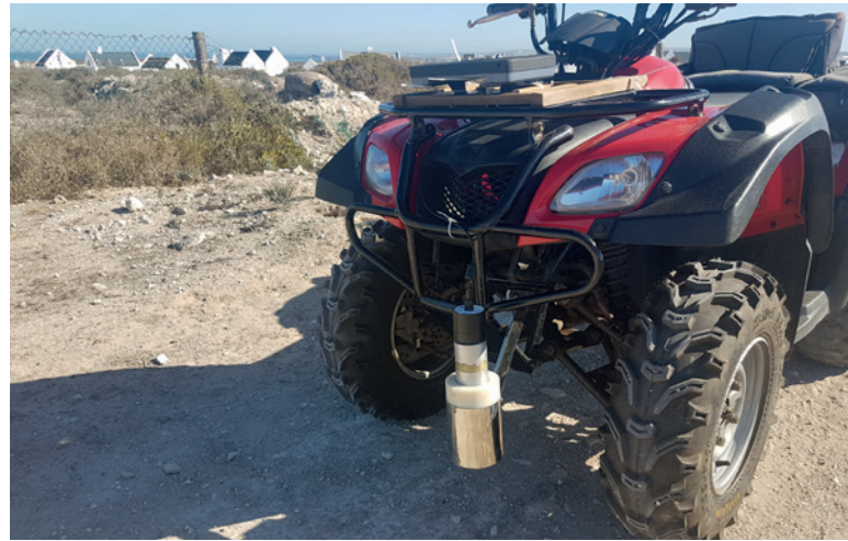
Sistema de detección de espectrometría gamma portátil GISPI (Gamma in Situ Portable Device) montado delante de un vehículo, como los automóviles utilizados para trazar la radiactividad natural de los sedimentos en zonas costeras.
