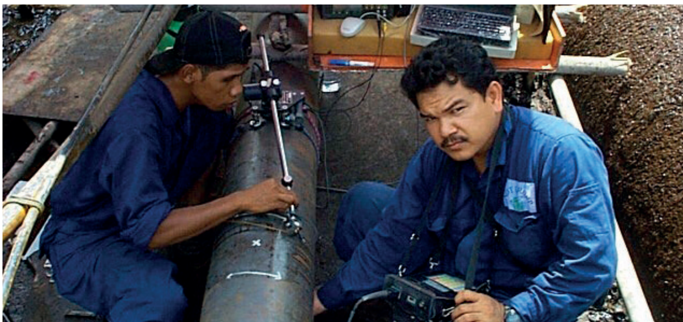
При проверке качества трубопровода компании “Петронас” технические специалисты обследуют одну из труб методом НРИ. (Фото: А. Насер Ибрахим/Учебный центр по НРИ им. Мадани)
